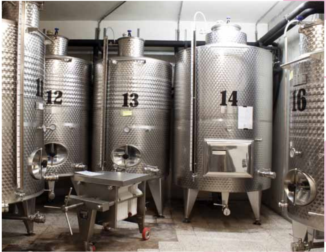
Vasche in acciaio inox per la fermentazione Stainless steel tanks for fermentation
